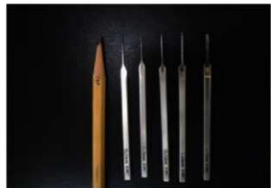
Ph.53 タングステン鋼製極細タガネ
