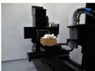
Ph.1 撮像した装置と大刀の設置状態
