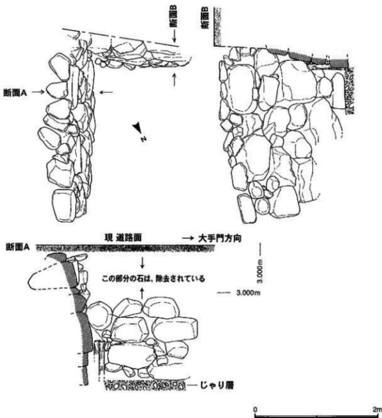
図6 石垣南端実測図 ( $S=1/40$ )
