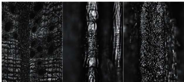
横断面 ——— 0.1mm 放射断面 ——— 0.1mm 接線断面 ——— 0.1mm 試料1. コナラ属アカガシ亜属 SC1
