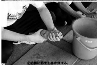
②芯棒に粘土を巻き付ける。
