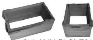
ブロックの木枠 (内寸：幅11×長19×深7.5cm)
