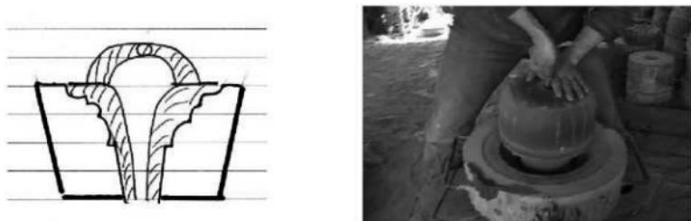
図41, 42 底型の中子を底型から抜き、甲型の中子に貼り付け、抜く
