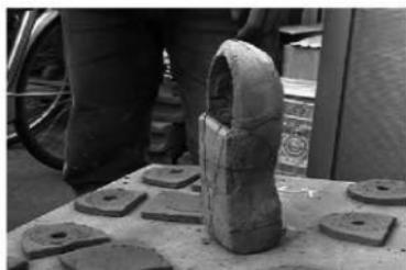
図34 張り合わせて埋め込み型とする
