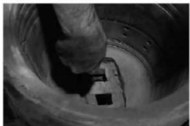
図 23 外型に竜頭の鉢型を埋け込む
