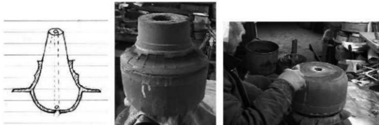
図43 斜線部分を削り取る
