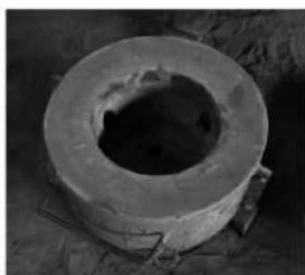
図35、36 獣脚の鋳型を埋け込む為の孔をあける
