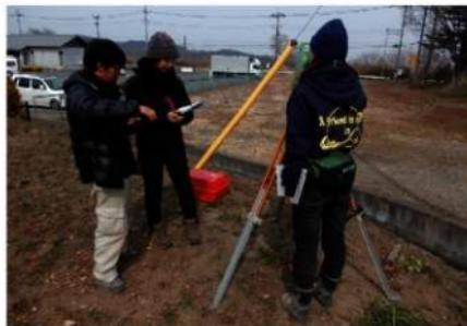
写真1 TSを用いたトラバース測量
