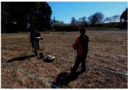
写真4 MALA社Pro-EXを用いたGPR探査
