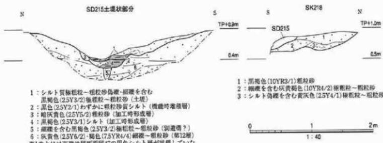
図7 12層上面遺構断面図
