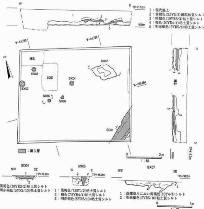
図4 北・東壁地層断面および遺構平面・断面図
