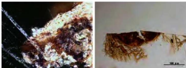
第125図 毛様観察箇所の断面観察（左図：横断面、右図：断面）
