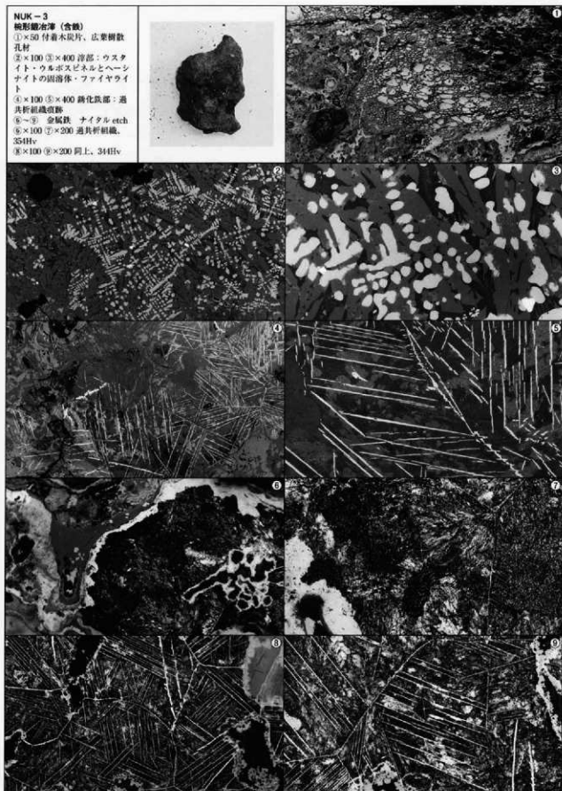
Photo.2 梃形鍛冶滓 (含鉄) の顕微鏡組織
