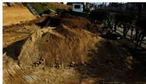
図 5-38 土壘復元に用いた土材の一部(手前から山土、河川堆積物)
