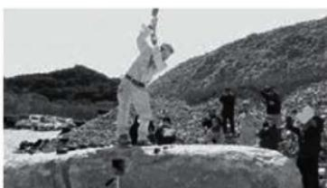
図22 玄能で鉄矢を叩く矢縛め（石割工程）
