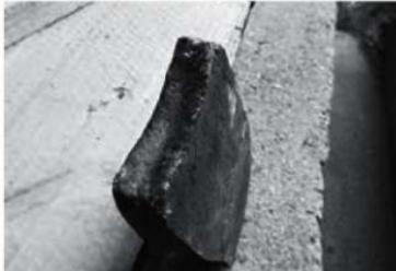
図20 復元した鉄矢の先端形状
