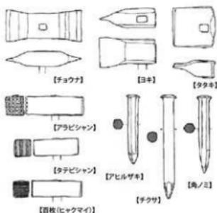
図1 下浦石工の細工道具（池田 2006）
