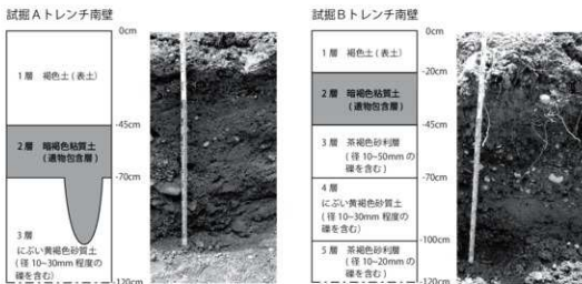
図5 試掘調査土層柱状図（1/20）
