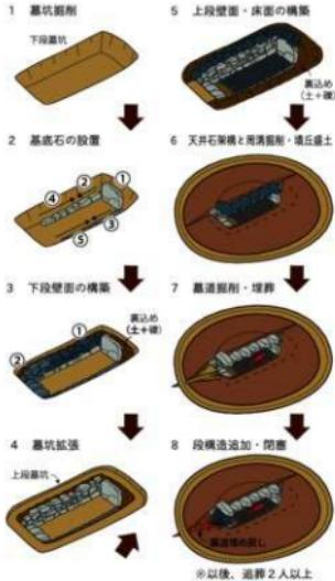
図1 中原4号墳の構築過程
