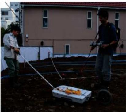
写真1 GPR探査使用機材
