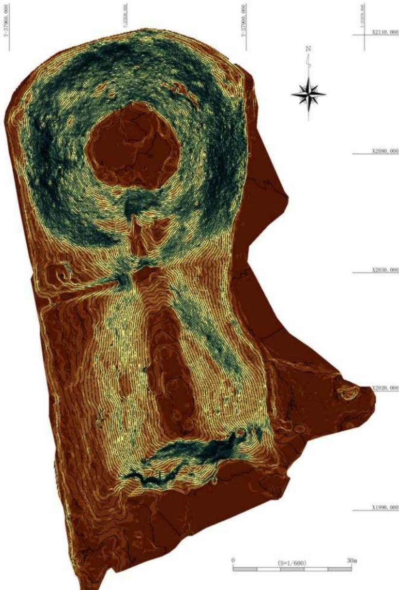
図15 野本将軍塚古墳の測量図 (10cm 等高線 + 20cm メッシュ Slope)
