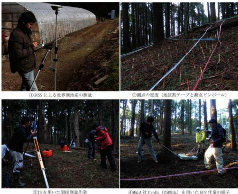
図1 山室姫塚古墳測量・GPR調査の作業風景
