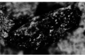
図23 第6層のスコリアの気孔中に飛び込んだ破砕岩片、破砕面は凹曲面と凸曲面で構成されている。粒径は2mm。
