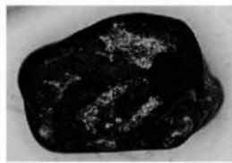
図22 第6層。微砂が詰まる長円形～条状痕破砕孔に微砂が詰まっている。礫は緻密玄武岩。粒径は4mm。
