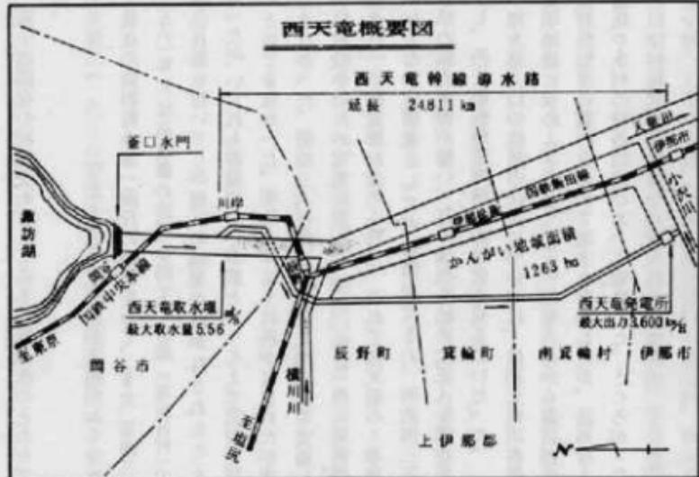
その後何度か補強工事を行ない、第一期工事の大改修を施工し、昭和三五年西天竜の非灌漑期の水を活用した県営発電事業が着工され、翌三六年一二月に発電が開始された。西天竜沿革史に「幾多の経緯を経て開拓してより昭和三四年の今日に至る三〇有余年、漸く熟田となり実に年間四万石の米産あり。從前の荒野を穀倉と変革せしめたのである。然れども幹線水路の老朽著しく、維持管理の面より非常に困難を來たし、早期改修の必要に迫られた。そこで非灌漑期の水を利用して発電し、売電と同時に幹線改修を行なう計画を樹てたのである。」と目的を書いている。なお、発電事業は、西天竜開削当時からの宿願であって、それが漸くかなえられたのである。そのため、全線にわたっての大改修と幹線の嵩上げ工事が施行された。なお、昭和五四年現在上流から大改修が行なわれている。
