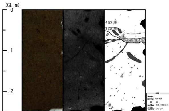
第53図 軟X線写真観察結果(北壁12) (左:実視 中:軟X線 右:解析結果)
