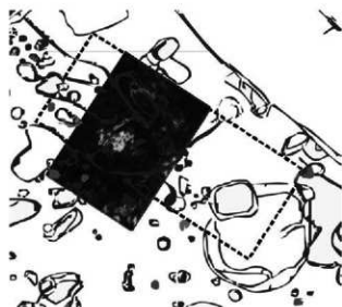
図 7.3 地形図に重ねた D 地区の深度スライス (深度 0.6～0.7m; 250MHz)
