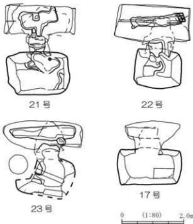
第23図 地下式横穴墓平面比較図
