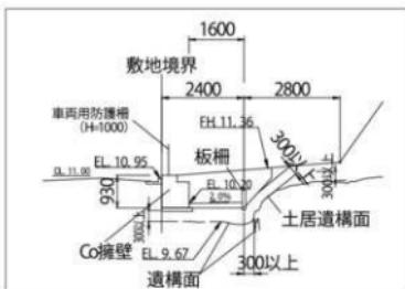
【図】コンクリート擁壁（下流側）断面図
