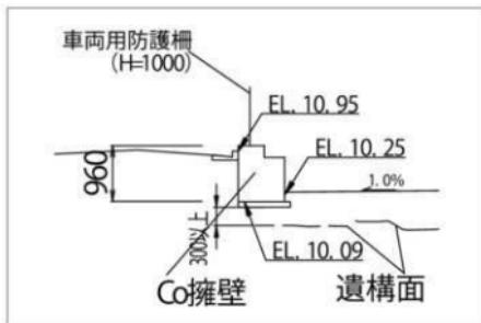
【図】コンクリート擁壁断面図
