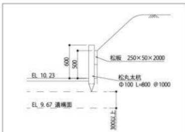
【図】板柵設置断面図
