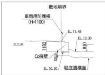
【図】コンクリート擁壁（上流側）断面図
