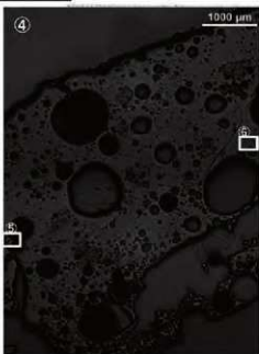
写真図版1 鉄滓・炉壁の顕微鏡組織
