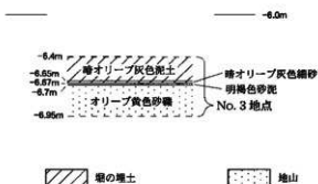
図14 堀跡遺構柱状断面図（1：40）
