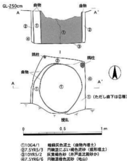
図13 井戸跡見通し断面図・平面図(1:20)
