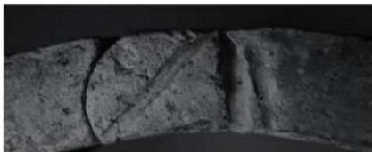
平瓦V類狭端面の藁の圧痕(16)
