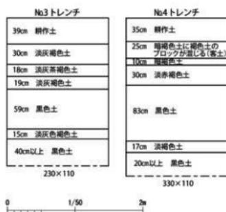
第27図 輪中堤③黒流地内トレンチ位置図(S=1/6000)・土層断面図(S=1/50)
