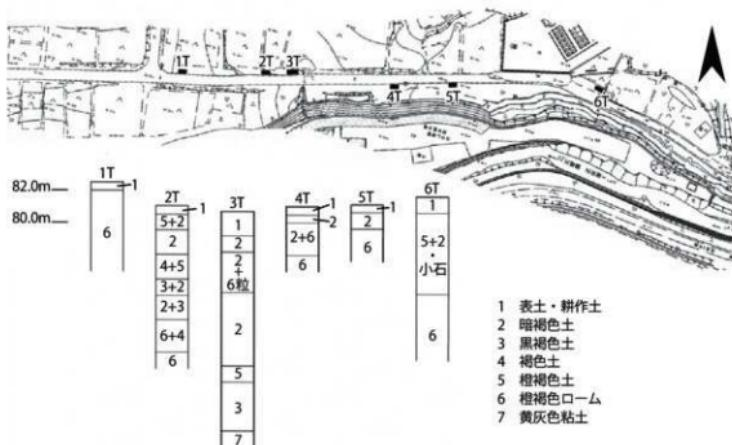
第 13 図 トレーニチ配置図 (1/1,500) 及び土層柱状図 (1/30)
