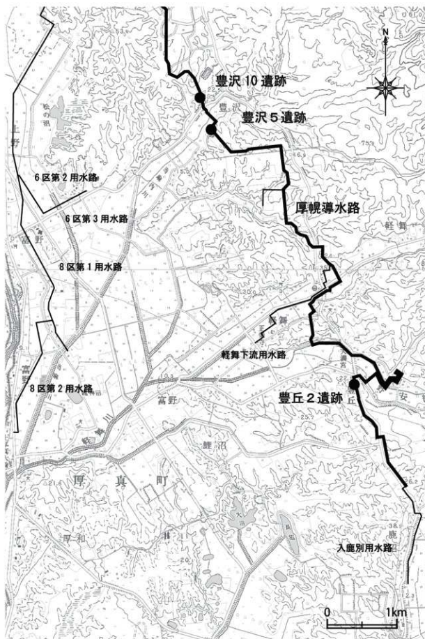
図1-2 厚幌導水路計画路線と遺跡の位置（豊沢5、豊沢10、豊丘2の各遺跡）
