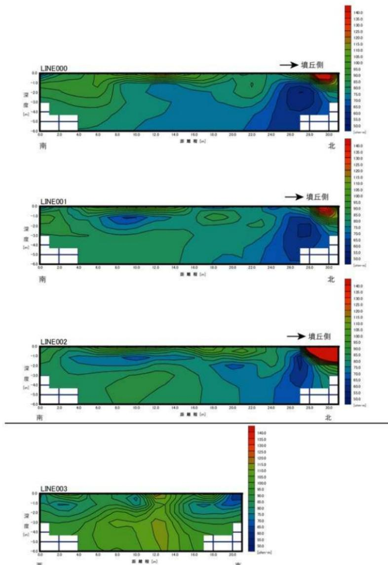
図37 電気比抵抗探査結果（比抵抗断面図）
