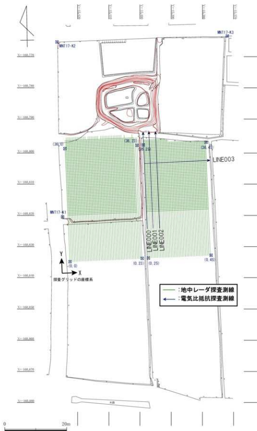
図32 探査測線図 (S=1/600)
