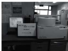
蛍光X線分析装置 日本電子製 JSX-3100R II
