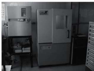
X線粉末回折装置(島津製作所製XRD6000型)
