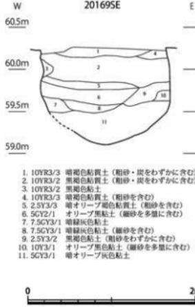
図 37 2 区 中層造構 井戸 平面・断面図 (S = 1/40)
