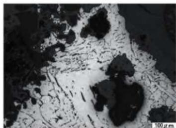
×100 金属顕微鏡組織写真 (試料No.16-1)
