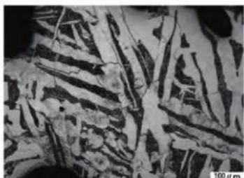
×100 金属顕微鏡組織写真 (試料No.46-1)
