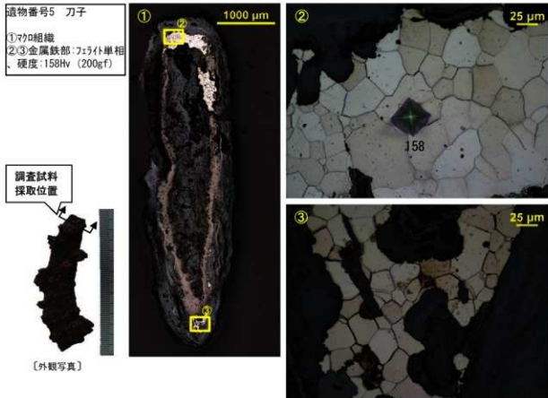
図版3. 刀子（遺物番号5）の顕微鏡組織・EPMA調査結果
