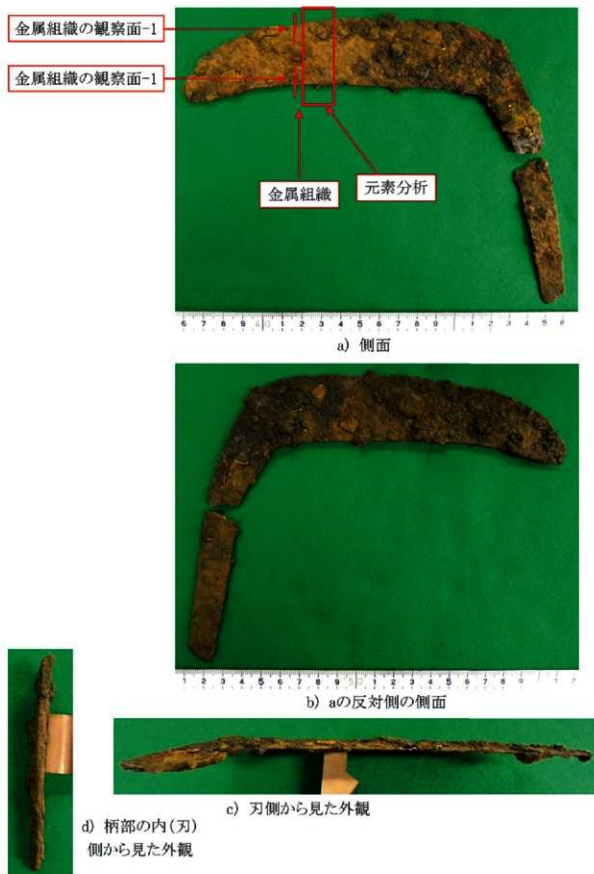
図版V-5 分析対象鉄製品 鎌(シ4-6)と試料採取位置
