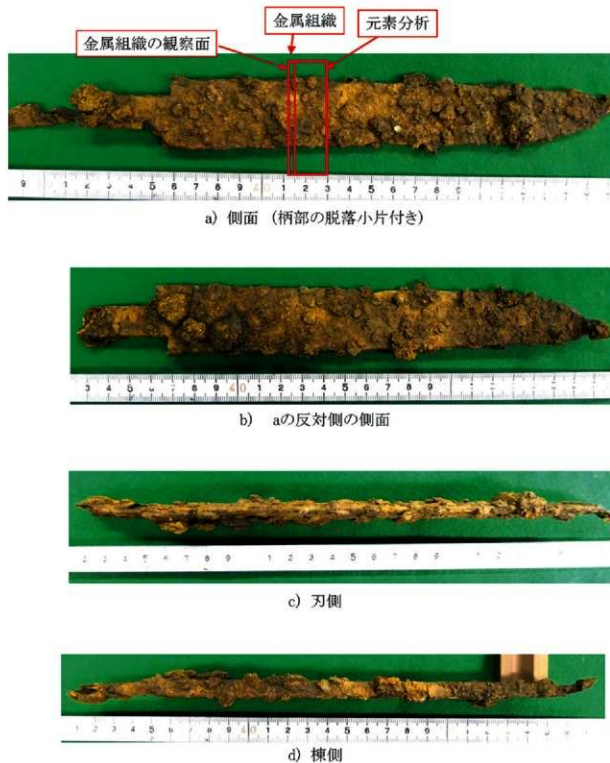
図版V-4 分析対象鉄製品 小刀(シ4-4)と試料採取位置
