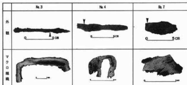
図4 No.3・No.4・No.7の外観と抽出した試料片のマクロ組織
