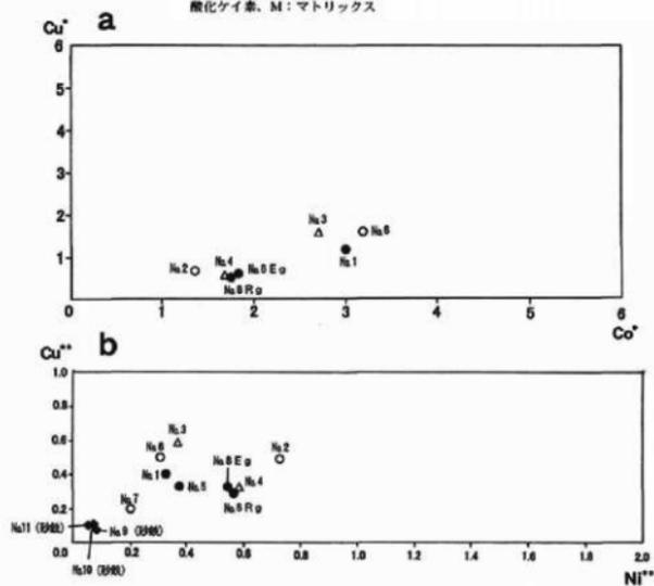
図8 出土鉄器に含有されるCu、Ni、Co三成分比
