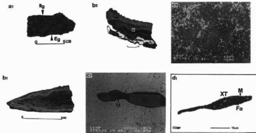
図2 No.8の外観と抽出した試料片の組織観察結果
