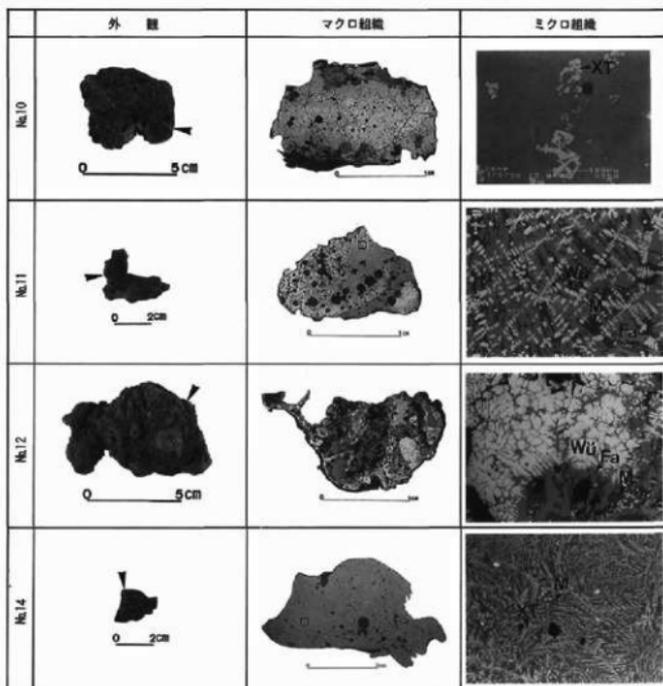
図7 No.10・11・12・14の外観と擴大した試料片の組織観察結果
