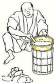
瓦漏を覆った粘土は、乾いてひび割れた頃にすり取
