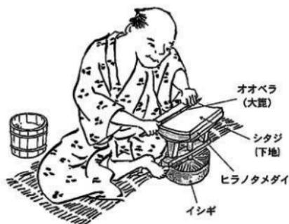
適度あてどに乾燥させたシタジをヒラノタメダイにのせ、オオベラでみがきます。瓦の部位によって、コテ、ヘラを使います。みがくことで表面に光沢が出て、水が染み込みにくくなります。これらの作業を終え、さらに乾燥させたものをシラジといひます。
