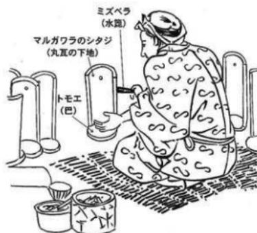
軒先模様の部分は、トモエノカタに粘土を押し込んでつくります。マルガワラのシタジとの接合部分は、カキヤブリで備をつけて接合し、ミズベラやナデイタで整えます。
