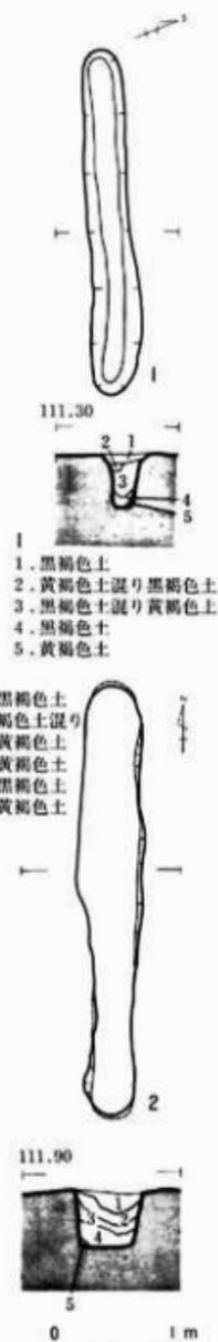
第47図 LE 56-0325 陥し穴状遺構平・断面図
