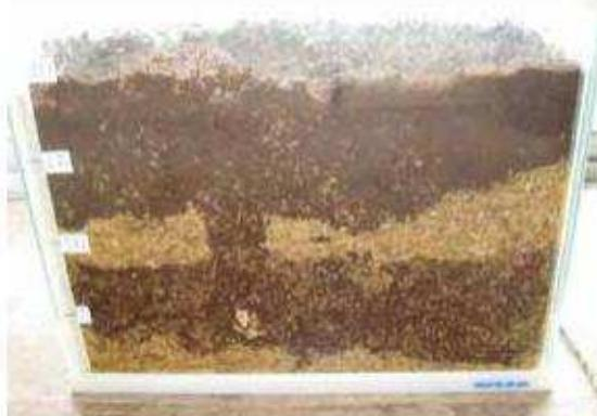
写真18 土層堆積状況の変化(70日目:20140613)
