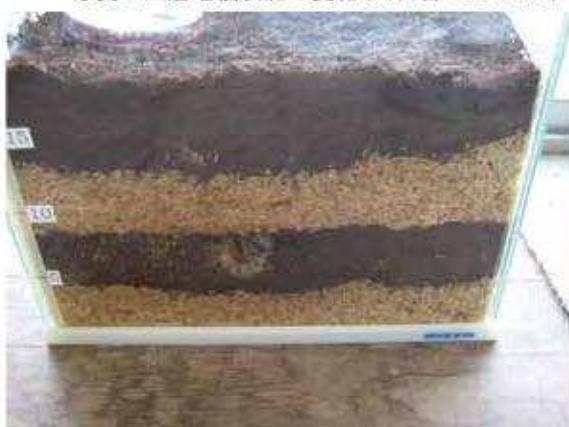
写真10 土層堆積状況の変化(24日目:20140428)
