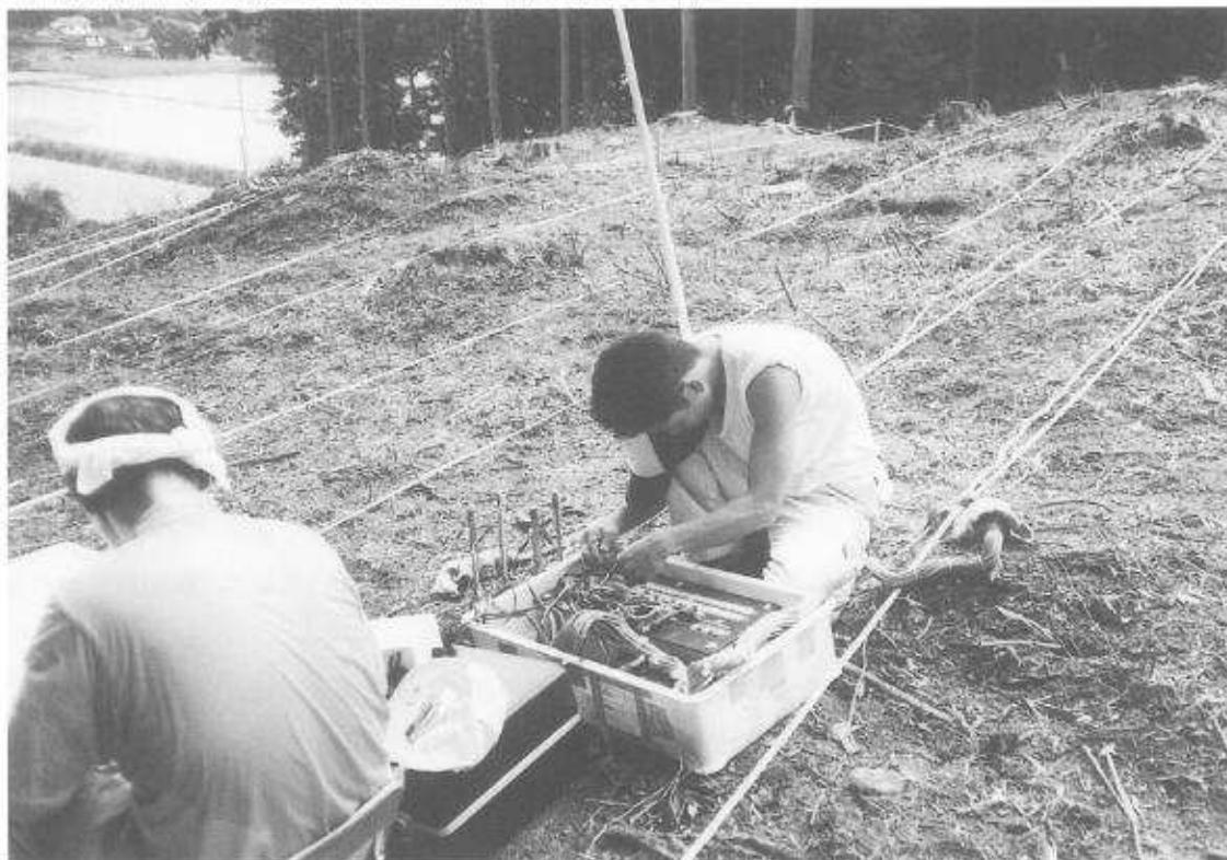
第75図 電気探査の状況
