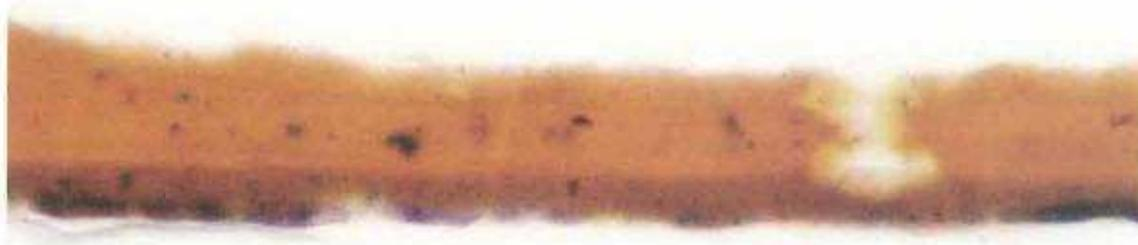
写真3 漆膜の断面写真①
