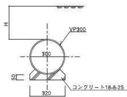
図33 暗渠管VP300標準断面図 (S=1/20) (単位:mm)
