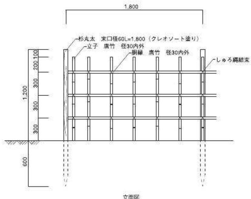
図54 四つ目垣詳細図 (S=1/30) (単位:mm)
