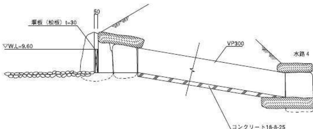
図32 水位調整部断面図 (S=1/30) (単位:mm)
