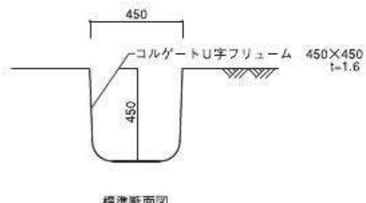
図31 コルゲートフレーム標準断面図 (S=1/20) (単位:mm)
