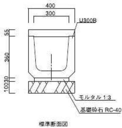
図30 U-300B標準断面図 (S=1/20) (単位:mm)
