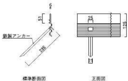
図53 根切板詳細図 (S=1/10) (単位:mm)
