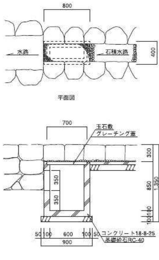
図28 集水樹詳細図 (S=1/40) (単位:mm)
