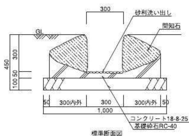
図29 石積水路標準断面図 (S=1/20) (単位:mm)
