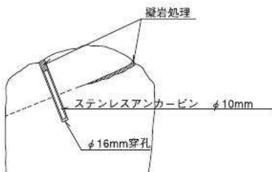
図24 景石修復標準詳細図 (S=1/10)
