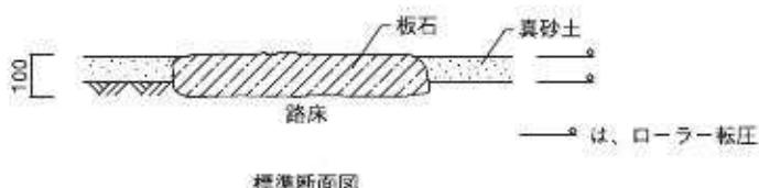
図36 板石据付標準断面図 (S=1/20) (単位:mm)
