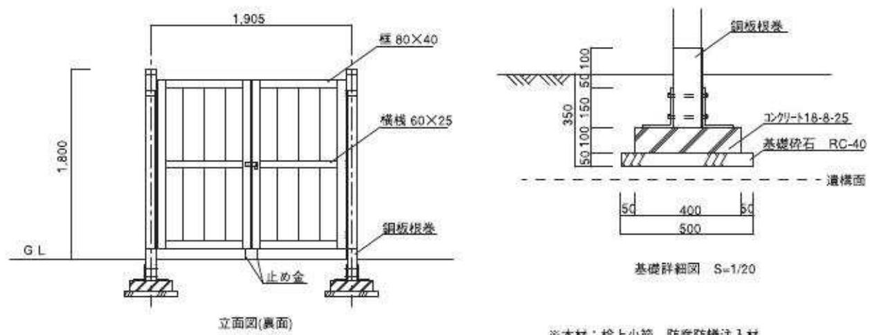
図39 人止柵詳細図 (S=1/50・S=1/20) (単位:mm)
