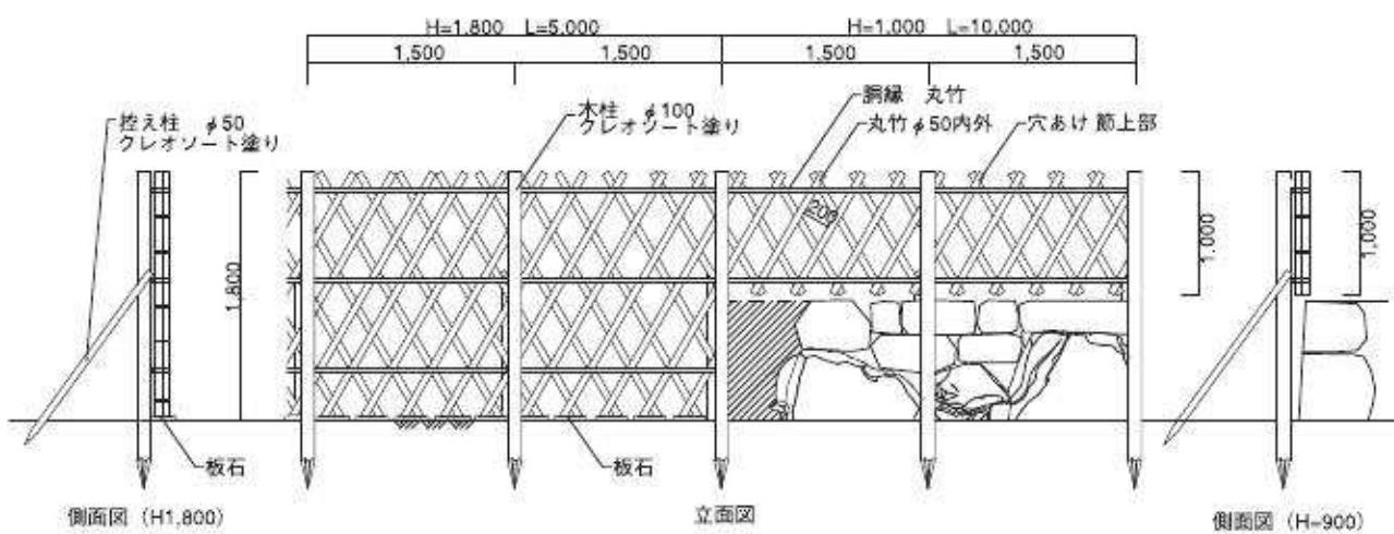
図55 竹矢來詳細図 (S=1/60) (単位:mm)
