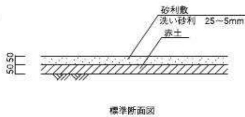
図35 砂利敷標準断面図 (S=1/20) (単位:mm)
