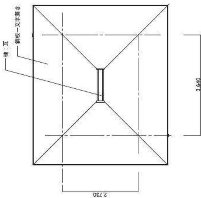
図47 屋根伏せ図 (S=1/80)　図48 小屋伏せ図 (S=1/80) (単位:mm)
