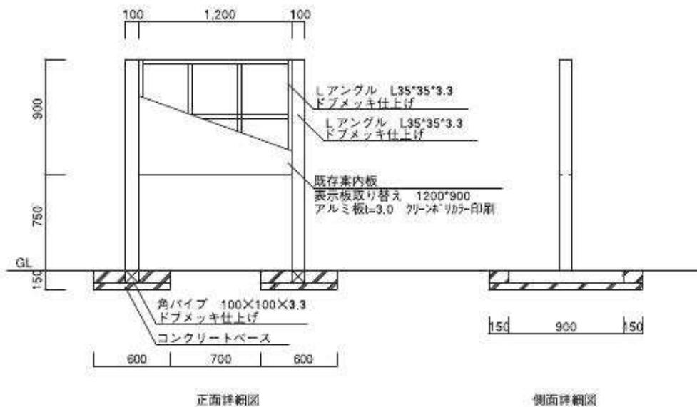
図51 案内板詳細図 (S=1/40) (単位:mm)
