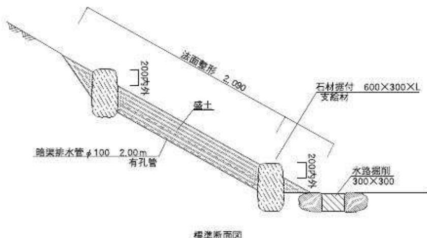
図56 法面整形標準断面図 (S=1/50) (単位: mm)
