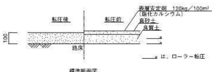
図34 土舗装標準断面図 (S=1/20) (単位:mm)
