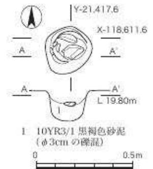
図 5 柱穴 6 実測図 (1/20)
