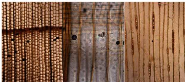
横断面 ——— 0.1mm放射断面 ——— 0.1mm接線断面 ——— 0.1mm 4. サワラ 第4検出面溝2 杭№20
