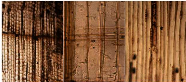
横断面 ——— 0.1mm放射断面 ——— 0.1mm接線断面 ——— 0.1mm 8. サワラ 第4検出面溝2 杭№28
