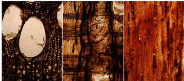
横断面 ——— 0.1mm放射断面 ——— 0.1mm接線断面 ——— 0.1mm 6. クリ 第4検出面溝2 杭№22
