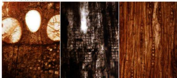
横断面 0.1mm放射断面 0.1mm接線断面 0.1mm 11. サワラ 第4検出面溝2 杭№44
