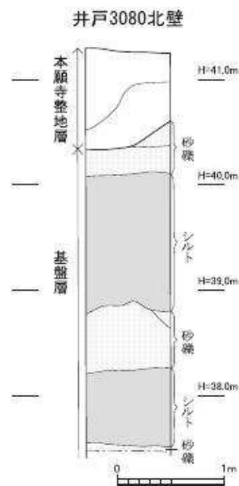
図50 基盤層堆積模式図 (1 : 50)
