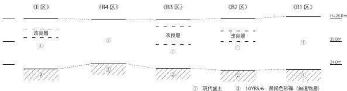
図 16 B・E区 断面柱状図（1：100）
