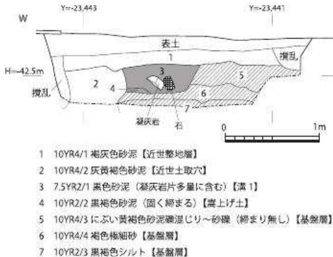
図6 北壁断面図 (1:40)
